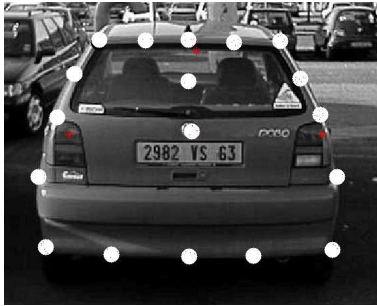
FIG. 3 – Position dans l’image des 18 caractéristiques \mathcal{F}_i formant le modèle du véhicule
